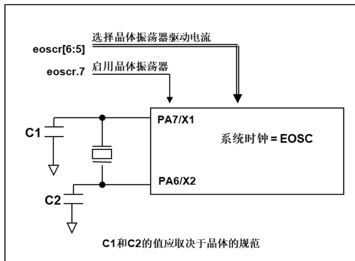
图 2: 晶体振荡器的硬件连接图
