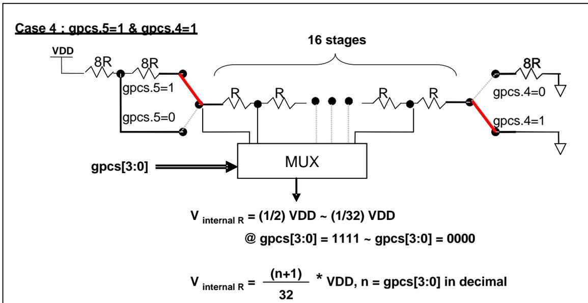
图 8:  $V_{\text{internal R}}$  硬件接法(gpcs.5=1 & gpcs.4=1)
