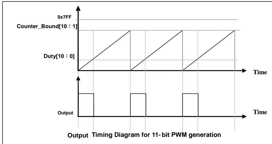
图 15: 11 位 PWM 生成器输出时序图
