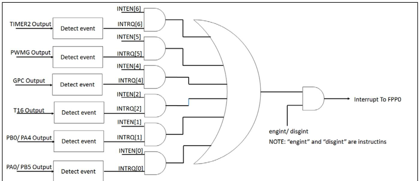
图 17: 中断控制器硬件框图
