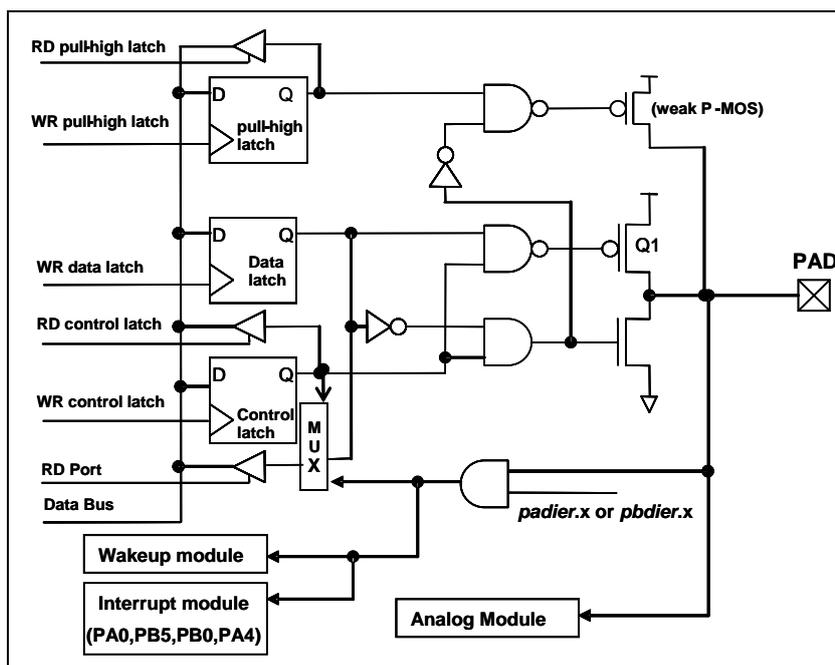
图 18: IO 引脚缓冲区硬件图
